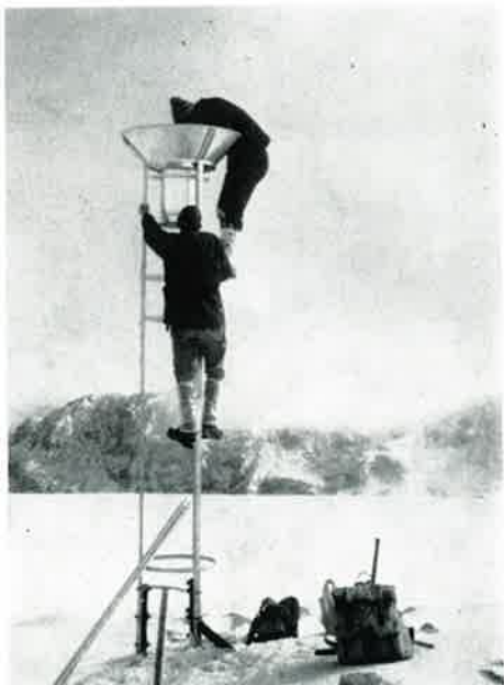
Die erste Ableseung am neu aufgestellten Totalisator
