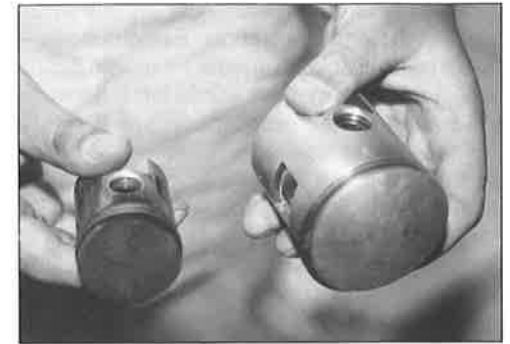
Des Mofapudels Kern liegt hier in der Hand. Allein der Größenunterschied zeigt die unterschiedliche Leistungsfähigkeit.
